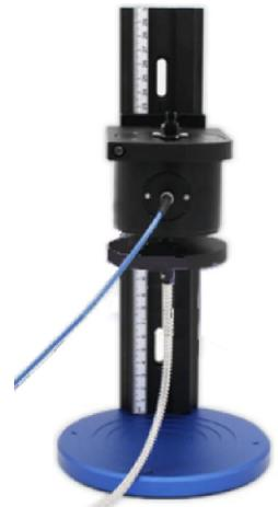
AO-TRS透反射积分球测试台
