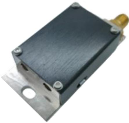
根据现有的材料特性，格物光学设计了基于  $\text{TeO}_2$  横波声学模式的 AOTF 产品。波长范围覆盖 350–2500 nm。在每个波长范围内都能实现最佳性能，并满足大多数应用：分辨率低至 1 nm，FOV 角度高达 20 度，孔径高达 10 mm。
