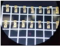
格物光学的增益芯片（Gain chip）系列产品，是可以用作外腔半导体激光器光增益介质的半导体光元件。格物光学可以提供低反射率类型或高反射率类型作为垂直刻面侧的反射率。且可以供应Chip 或COC类型的产品，也可以根据客户需求封装成器件供货。
