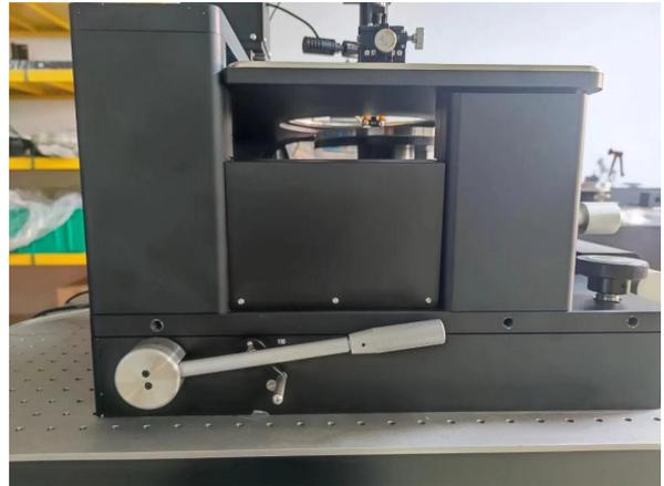
针座台面6级不连续机械抬杆快速升降，4套导轨丝杆同步微调升降
